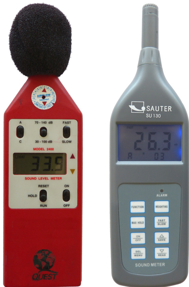
Professionelle und Semi-Professionelle Geräte. Mit dem rechten Gerät kann auch der energieäquivalente Schallpegel über einen Zeitraum bestimmt werden.
