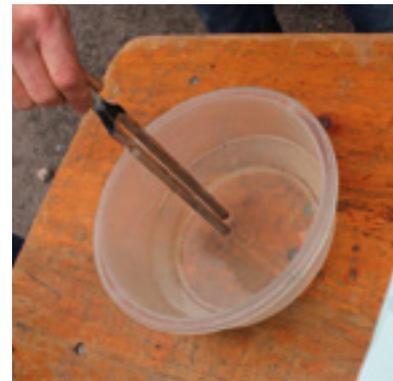
Mithilfe einer Stimmgabel werden Schallwellen in einer Wasserschale sichtbar.
